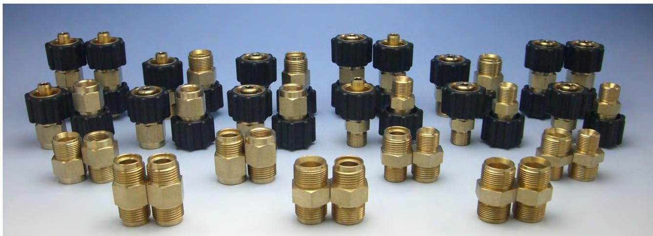
**製品概要** 高圧洗浄機で多く用いられている、手締めで取り付けが可能な、工具を必要としないナットカップリングです。高水圧及び高温水にも対応しており、洗浄ガンや高圧洗浄機本体からの着脱が容易に行えます。数十種類の品目があり、無加圧状態であれば、全品とも接続後に回転する機能を有しているため、ホースや洗浄ガンなどのねじれを解消することができます。
