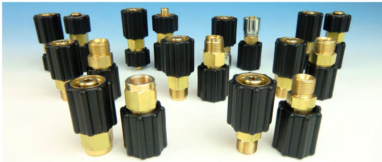
**製品概要** NCタイプに特殊ボールベアリングを内蔵したNCスイベルタイプです。加圧状態でも低い回転トルクで回転する機能を有しており、洗浄作業中のホースや洗浄ガンなどのねじれを解消することが出来る為、作業性の向上と洗浄ホースの金具付近部分の破損を防止することが出来ます。
